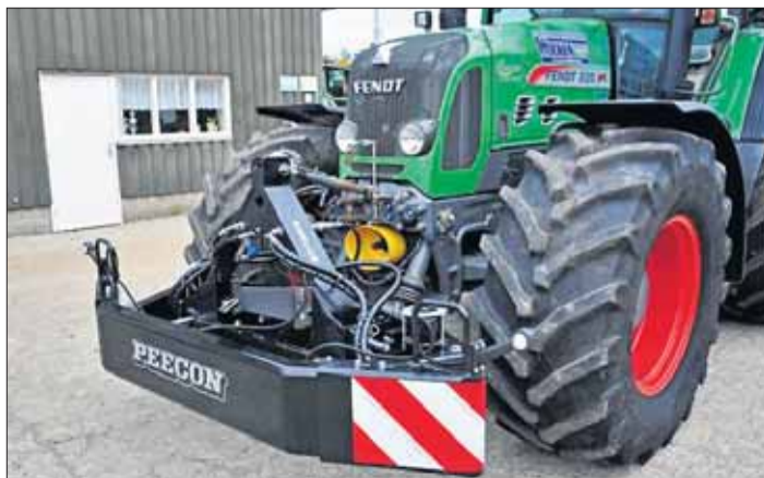
Tien loonbedrijven gaan dit najaar proefrijden met de botsabsorber van Peecon. Die vangt energie die vrijkomt bij een botsing op en voorkomt dat een auto onder de trekker schiet. Foto Cumela
